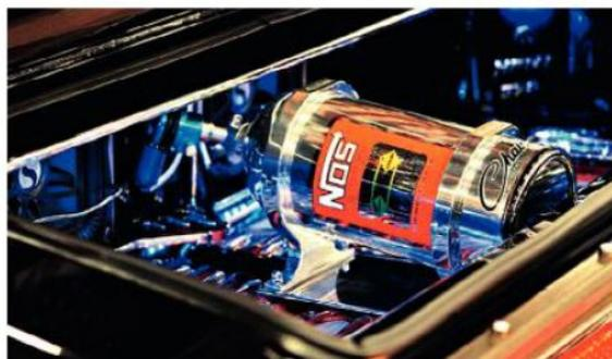
Le protoxyde d'azote  $N_2O(g)$  est un gaz utilisé pour améliorer les performances des moteurs de voitures par un apport de dioxygène. Rendus populaires dans le film *Fast and Furious*, les systèmes NOS (Nitrous Oxide Systems) permettent d'injecter le protoxyde d'azote  $N_2O(g)$  dans la chambre de combustion du moteur, en même temps que l'air et l'essence. Lors de la compression, le gaz se réchauffe, se décompose en produisant du dioxygène selon la réaction d'équation :
